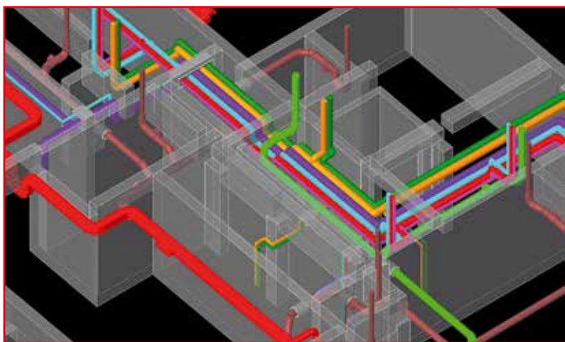
Modelowanie instalacji nabiera znaczenia przy ich prowadzeniu przestrzennym i dużym zagęszczeniu, ułatwia zaprojektowanie, odbiór projektu przez wykonawcę i realizację. Instalacje w piwnicy budynku wielorodzinnego
