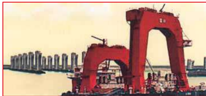
Rys. 6. Statek „Ostrea” do transportu filarów zapory
