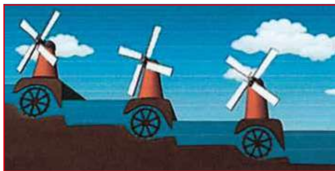
Rys. 8. Tak ustawiano kolejne wiatraki pozwalające na pompowanie wody z niższego na wyższy poziom
