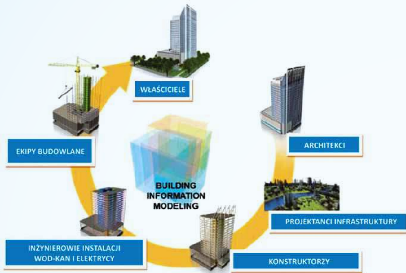
Rys. 5. Przepływ informacji projektowych
