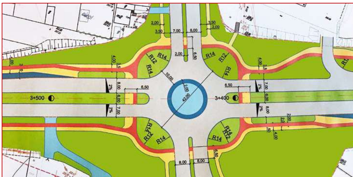
Rys. nr 1. Przebudowa istniejącej wyspy centralnej na skrzyżowaniu ulic: Dzieci Zamojszczyzny, Śląskiej i Szczepieskiej na rondo
