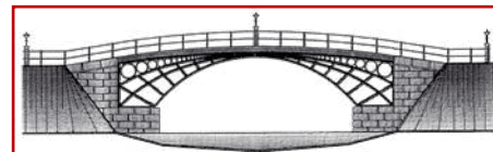
Rys. 2. Most nad rzeką Strzegomką w Łażanach. Rok budowy 1796. Zachowały się elementy poręczy, pomostu i fragmenty łuków
