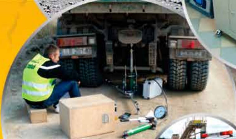
WSKAŹNIKI ZAGĘSZCZENIA I NOŚNOŚCI: PŁYTA DYNAMICZNA, VSS, SONDA SD-10
