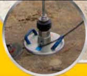
WSKAŹNIKI ZAGĘSZCZENIA I NOŚNOŚCI: PŁYTA DYNAMICZNA, VSS, SONDA SD-10
