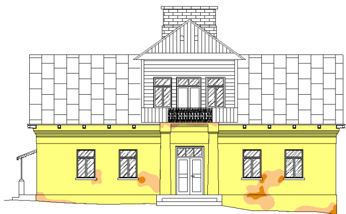
Rys. 8. Inwentaryzacja uszkodzeń elewacji południowej
