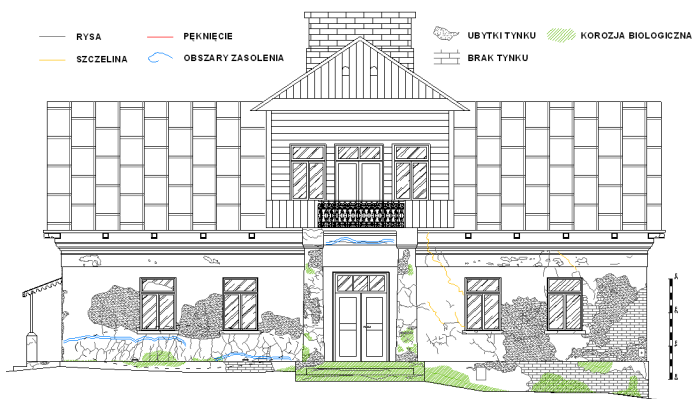
Rys. 8. Inwentaryzacja uszkodzeń elewacji południowej
