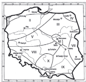
Regiony helioenergetyczne Polski [Ekspertyza pod red. prof. dr Wiesława Gogóła, Konwersja termiczna energii promieniowania słonecznego w warunkach krajowych, Polska Akademia Nauk. Wydział Nauk Technicznych. Komitet Termodynamiki i Spalania. Warszawa, 1993]
