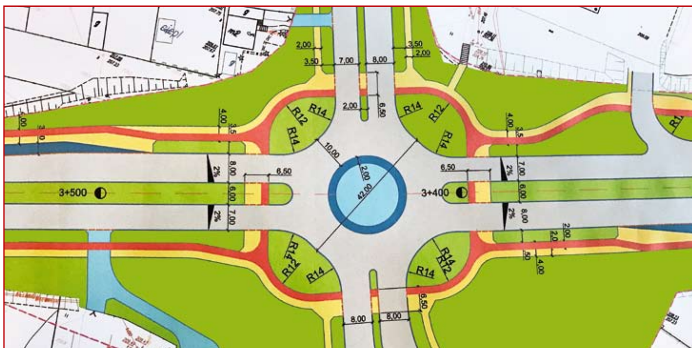
Rys. nr 1. Przebudowa istniejącej wyspy centralnej na skrzyżowaniu ulic: Dzieci Zamojszczyzny, Śląskiej i Szczembrzeskiej na rondo
