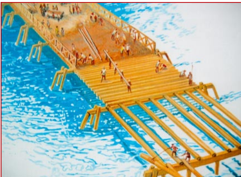
1. Próba rekonstrukcji mostu „Cezara” wg zachowanych szkiców. Mosty – Rejner Kothe 1993.
