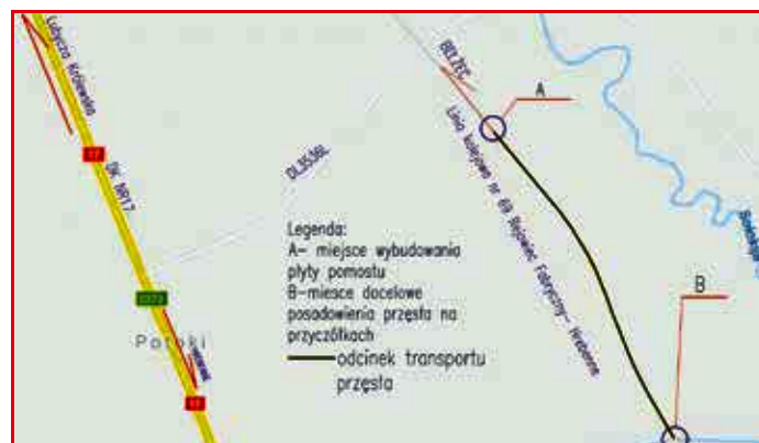
Rys. 2. Lokalizacja miejsca przebudowy mostu
